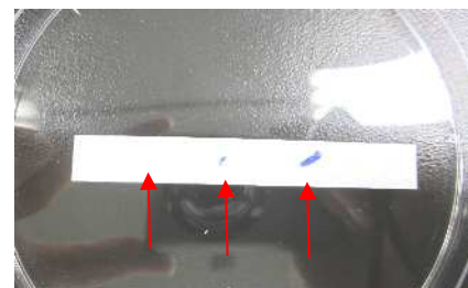
検体№5 6 7 【写真2】オキシダーゼ試験 検体 5：陰性 検体 6,7：陽性
