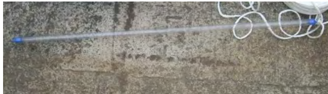
ベラー採水器の例（左：採水状況、右：採水器本体）
