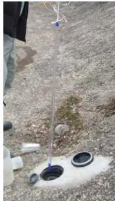
ベラー採水器の例（左：採水状況、右：採水器本体）
