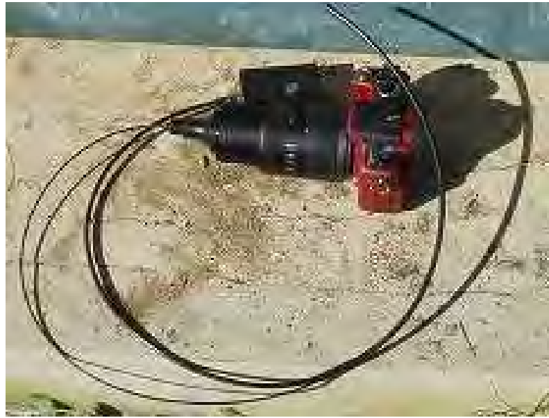
ファイバースコープの例 (㈱環境地質提供) (カメラを取り付けた例。ビデオを取り付けることも可能)
