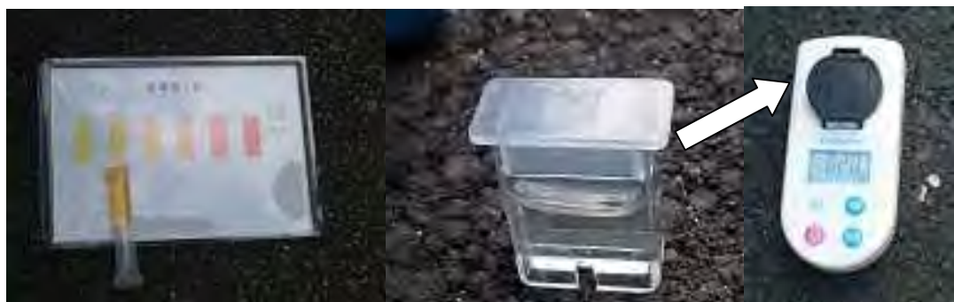
左：パックテストの測定例、中・右：デジタルパックテストの測定例
