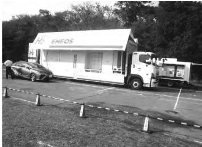
キャンプ淵野辺留保地で運用する 移動式水素ステーション
