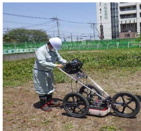
【写真-3】地中レーダ探査
